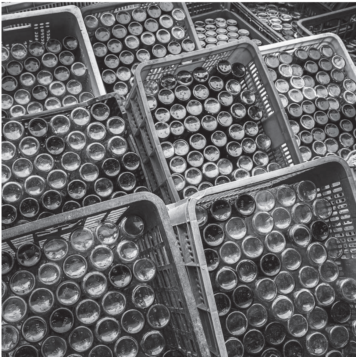
清洗完成的玻璃瓶會依序排進塑膠籃，待自然晾乾後便可交給工廠
